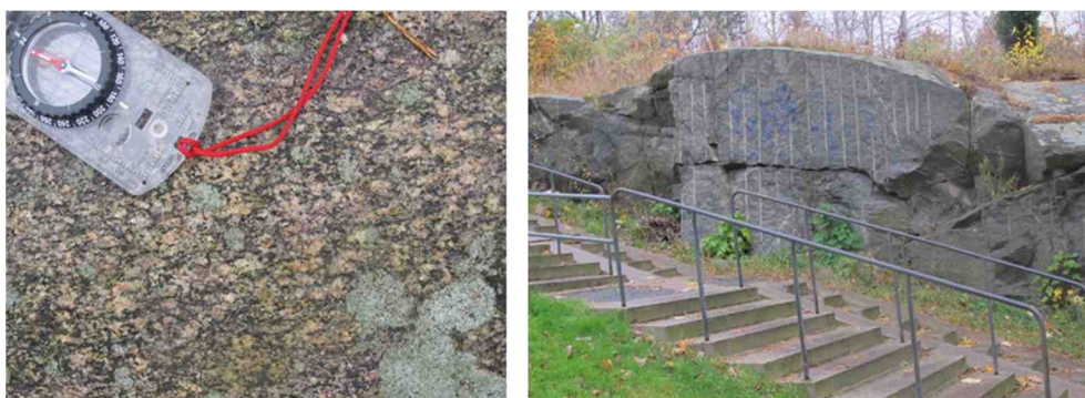
Figur 5. Svagt gnejsig granodiorit (vänster). Storblockigt uppsprucket berg (höger).
